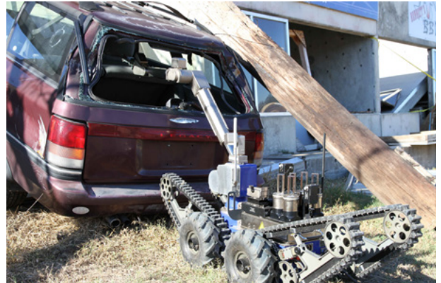
Mit mobilen ferngesteuerten Robotersystemen können Einsatzkräfte aus sicherer Entfernung Gefährdungslagen aufklären und Gefahrenquellen beseitigen.
