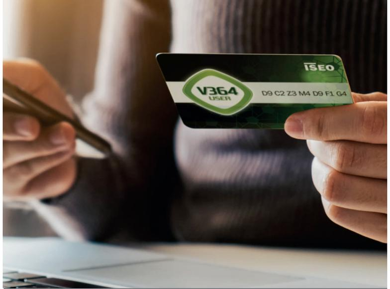
Bei RFID-Identmedien handelt es sich um physische Identmedien, die verschiedene Formen haben, zum Beispiel Karte, Schlüsselanhänger, Armband. RFID-Identmedien sind komplett passiv, sie beinhalten keine Batterie. Die Öffnungsenergie wird über das RFID-Lesegerät übertragen, wenn das RFID-Identmedium in die Nähe des Lesegeräts gehalten wird.
